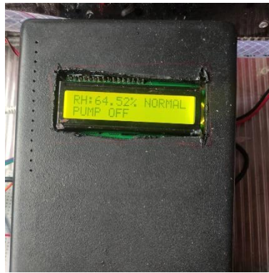
Gambar 4. Tampilan LCD Sistem Penyiraman Bibit Tanaman Cabai
