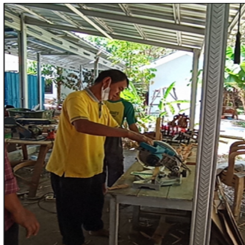
Gambar 6. Memotong Komponen dengan Mesin (difabel tidak boleh mengerjakan) (Sumber: Tim PkM Maospati, 2024)
